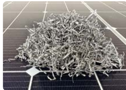
Leiterbahnen (verzinnertes Kupfer)
